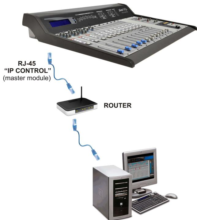
Una vez que la 2600/VI es conectada al *router*, se accede a la Interfaz Virtual de control desde cualquier computadora de la LAN, usando un navegador e ingresando en la barra de direcciones lo siguiente:
